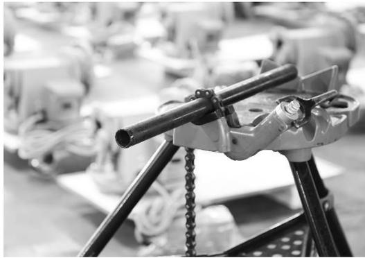
3. Закрепите опорный рычаг на трубе так, чтобы направляющая клуппа была параллельна самой трубе.
